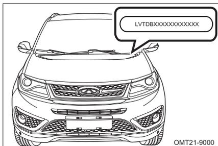
Идентификационный номер автомобиля (VIN) нанесен в верхнем левом углу передней панели со стороны водителя и виден снаружи автомобиля через ветровое стекло.
